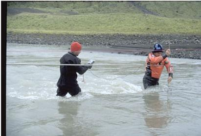
*Figura 9 – Realizzazioni delle misure di velocità dell'acqua del fiume Krvia (foto Soraya Ayub)*
